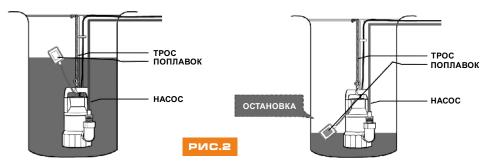
**(I) Внимание!** Убедитесь в отсутствии препятствий для перемещения поплавка. Если хотите изменить регулировку, следует изменить вылет поплавка относительно места крепления его кабеля на рукоятке. Проверьте, что объем воды в пределах min и max поля регулирования по отношению к количеству перекачиваемой воды не
